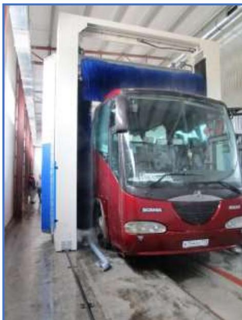
L'impianto deve essere dotato di alta pressione ed alimentato tramite catena porta cavi
