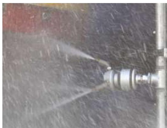
L'alta pressione è generata da una pompa da 15 Kw con portata di 350 l/m' e una pressione da 20 bar
